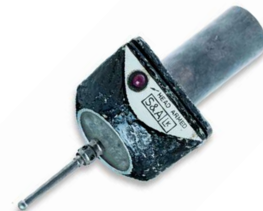
Первый триггерный контактный датчик компании Renishaw
